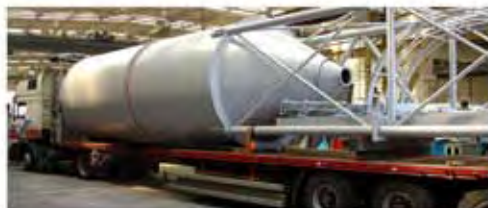
Uskladňovací ocelové silo pro syké materiály
